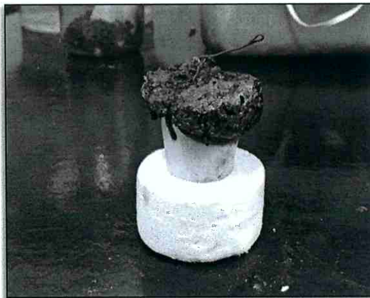
Figura 14 – Cadinho recém retirado do ensaio gravimétrico, aparente “espumamento” do carvão liquefeito
