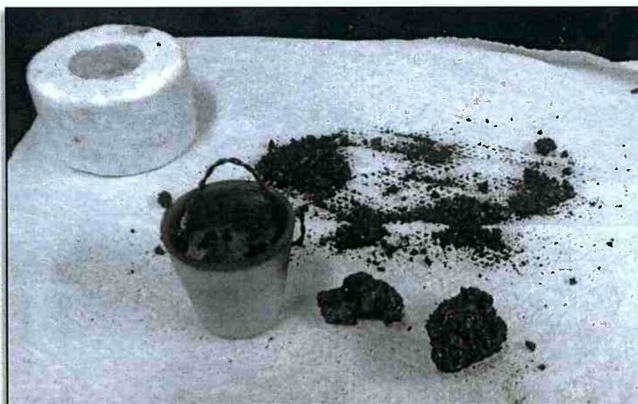
Figura 13 – Carga de carvão ensaiado no gravimétrico até 550°C
