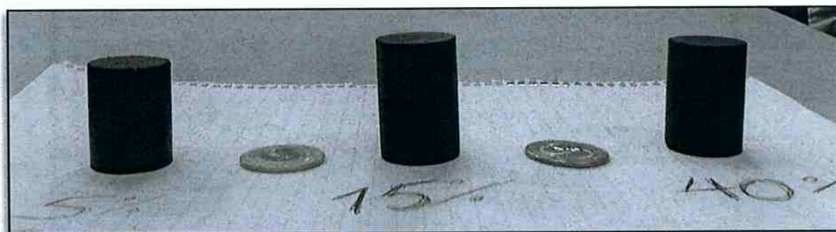
Figura 8 – Briquetes contendo 5%, 15% e 40% de minério de ferro logo após a briquetagem
