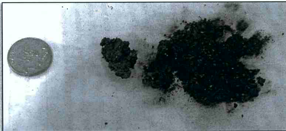
Figura 12 – Amostra composta de 100% de carvão levada à 550°C
